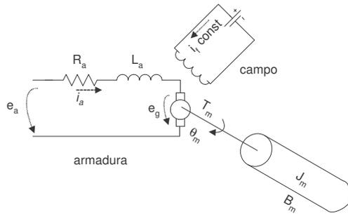
$$e_a(t) = K\dot{\theta}_m(t) + R_a i_a(t) + L_a \frac{di_a(t)}{dt}$$
